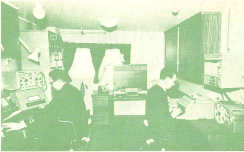
Sala radio della petroliera norvegese Norbella, che ha adottato il nuovo progetto Simplex TOR.
